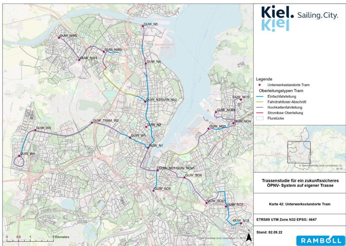
Abbildung 22 Position Gleichrichterunterwerke (GUW) Tram
