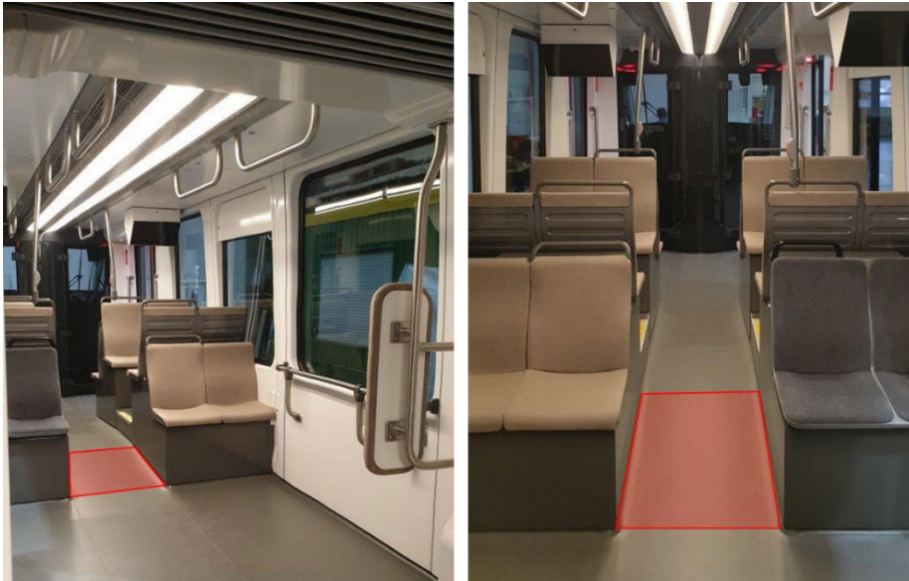
Abbildung 34 Längsrampen im Fahrzeug über den Fahrwerken
